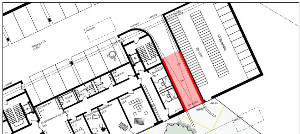
Abbildung 7: Einfahrt Einstellhalle mit Lärmschutz-Massnahmen
