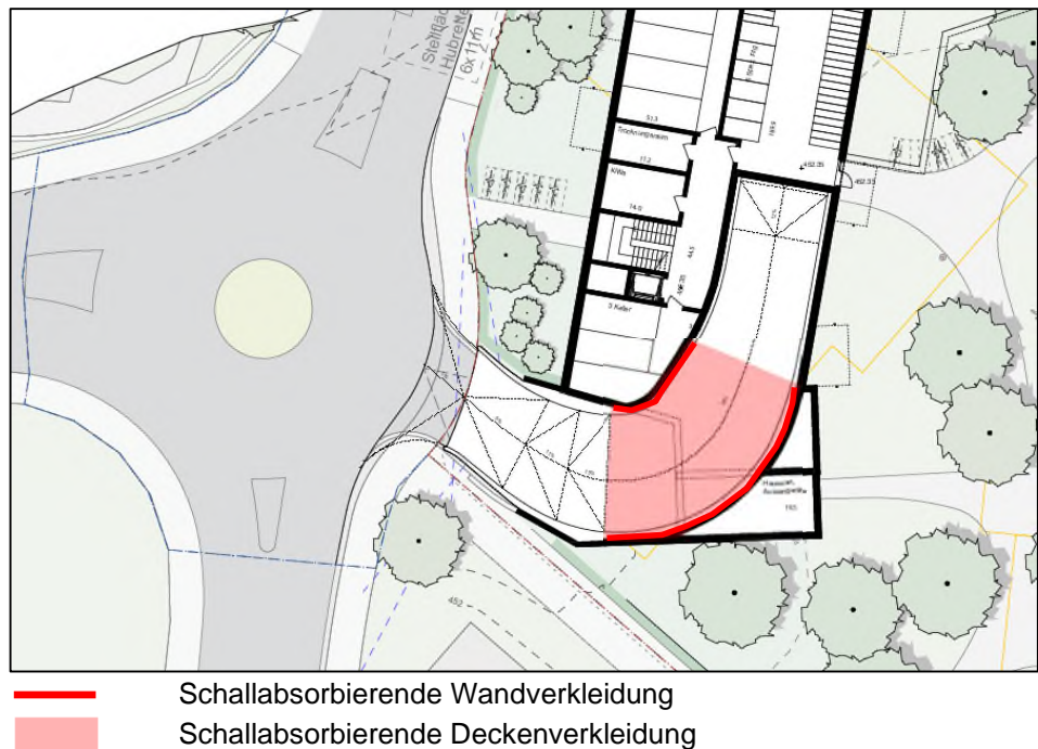
Abbildung 10: Einfahrt Einstellhalle mit Lärmschutz-Massnahmen
